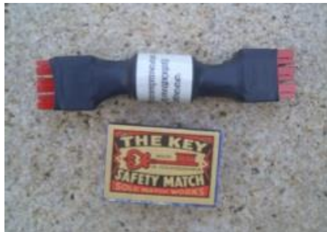
Bild 15 kompakter Verteiler mit 1 Eingang und 5 Ausgängen
