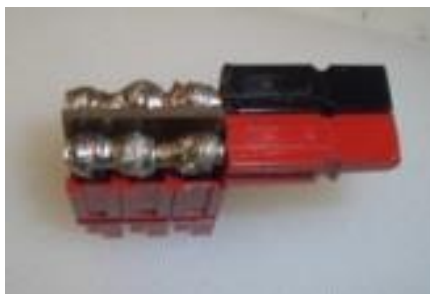
Bild 21 DJ9OZ – Block vor dem Isolieren mit Heißkleber
